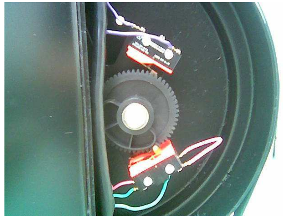
Ubicación de los fines de carrera, que limitan los movimientos de apertura y cierre. Sin ellos el motor giraría indefinidamente
